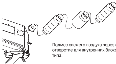
Комплект для подмеса свежего воздуха для внутренних блоков кассетного типа.
