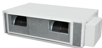
**Канальный тип** - мощные системы, обслуживающие через систему воздуховодов одновременно несколько помещений. Рециркуляция воздуха происходит следующим образом: забранный из помещений воздух проходит через внутренний блок кондиционера, оснащенный мощным вентилятором и снова подается в помещения по системе распределительных каналов.
